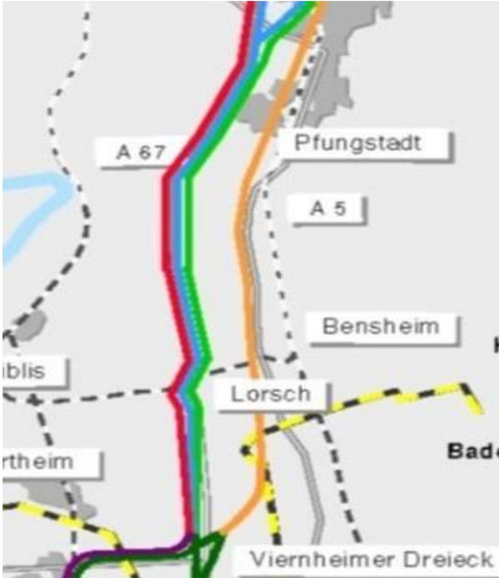
Die Variante IV wird gerne mit der Pro Bahn Variante verwechselt. Es erfolgt keine Rieddurchschneidung. Der Wechsel nach Westen erfolgt in der Höhe Lautenbach und führt zwischen Hemsbach und Hüttenfeld nach Westen.
